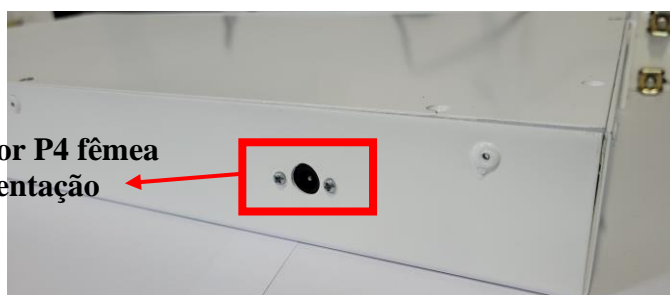
Figura 19 – Conector de alimentação visto na parte posterior do gabinete do PC
