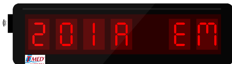
Figura 10 – Exemplo: DD exibindo uma chamada de emergência no Leito 201A.
