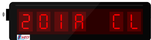
Figura 8 – Exemplo: DD exibindo uma chamada (comum) no Leito 201A.
