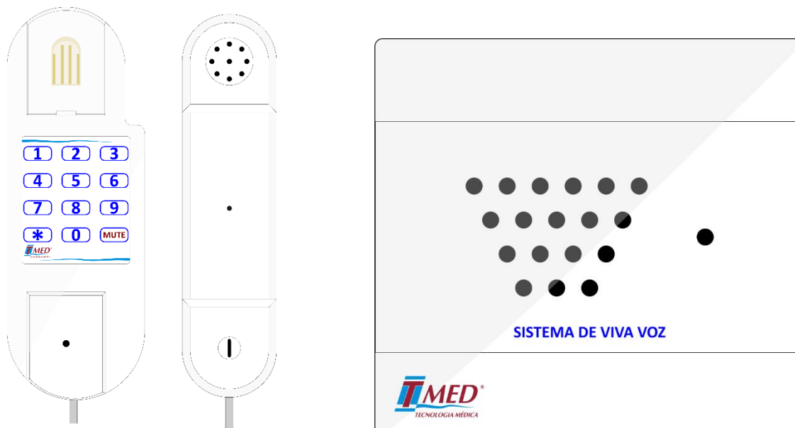
Figura 11 - Dispositivos opcionais em caso de atendimento por viva voz. À esquerda, interfone localizado no posto; à direita, módulo de comunicação instalado no leito e conectado à UC.
