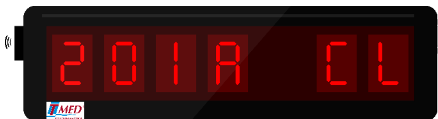
Figura 7 – Exemplo: DD exibindo uma chamada (comum ou de banheiro) no Leito 201A.
